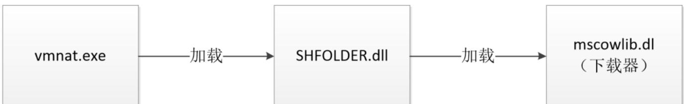
SHFOLDER.DLL会在计划任务\Microsoft\Windows\NetTrace\GatherNetworkInfo中添加action执行当前程序来实现持久化。早期的SHFOLDER.DLL会直接加载下载器文件，最新发现的SHFOLDER.DLL映射系统目录下的adsnt.dll文件，将下载器文件填充到adsnt.dll的映射的内存后加载执行。
